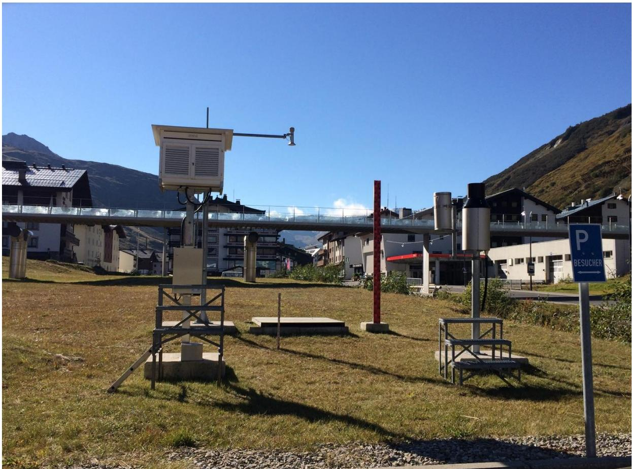
Abb. 16: Das Schneemessfeld in Zürs – im Bereich der Talstation der Hexenbodenbahn. Deutlich erkennbar ist die rote Schneemesslatte mit einer Höhe von drei Metern. Foto: [www.zukunft-skisport.at](http://www.zukunft-skisport.at)
